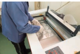
② 治具への設置 彫刻が定位置にくるように治具を用いて製品をセットしていきます。
