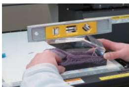
② 治具への設置 印刷物の形状に合わせた専用の治具の上に、印刷面が水平になるようにセットします。
